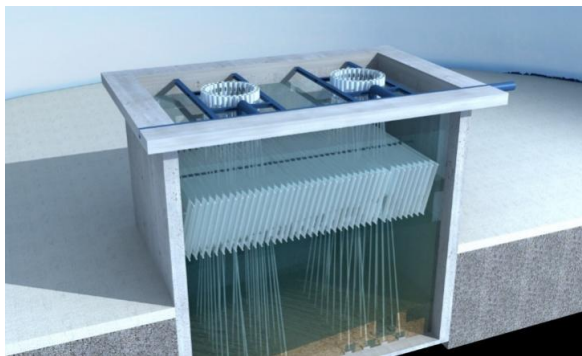
图 4-3 水解酸化工艺（上流式耦合水解反应器）示意图
